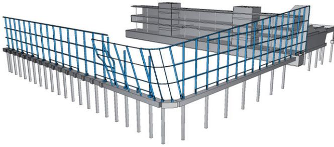
**Bild 7** Tragwerkselemente im Bereich der Süd- und Ostfassade
